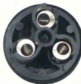
Figure 5 : Connexions des fils Fil marron à la borne L. Fil bleu à la borne N. Fil vert/jaune à la borne E.
