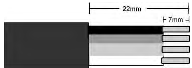
Entmantelung des Kabels
