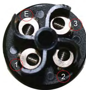
Figure 6 : Connexions des fils Fil marron à la borne 1 Fil noir à la borne 2 Fil gris à la borne 3 Fil vert/jaune à la borne E.
