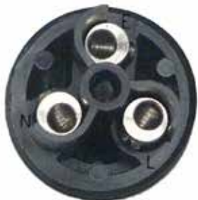
Figure 5: Conexiones de los cables Cable marrón a terminal L Cable azul a terminal N Cable verde/amarillo a terminal E
