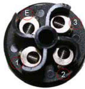
Abbildung 6: Kabelanschlüsse Braunes Kabel zu Anschluss 1 Schwarzes Kabel zu Anschluss 2 Graues Kabel zu Anschluss 3 Grünes/gelbes Kabel zu Anschluss E
