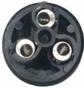
Abbildung 5: Kabelverbindungen Braunes Kabel zum Anschluss L Blaues Kabel zum Anschluss N Grünes/gelbes Kabel zum Anschluss E
