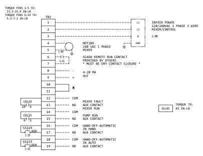
\*ONLY REMOVE FACTORY INSTALLED AUX INTERLOCK JUMPER WIRE FROM TB1:9 AND TB1:10 IF EXTERNAL DEVICE IS REQUIRED TO INHIBIT MIXER OPERATION. THE EXTERNAL INTERLOCK DEVICE (FLOAT LEVEL TANK, LEVEL CONTROLLER, REMOTE SWITCH, ETC.) MUST BE A NON POWERED DRY CONTACT (NORMALLY CLOSED) AND PROVIDE DELAY CIRCUITRY TO PREVENT MIXER SHORT/RAPID CYCLING, FAILURE TO DO SO WILL CAUSE MIXER DAMAGE AND VOID WARRANTY.
